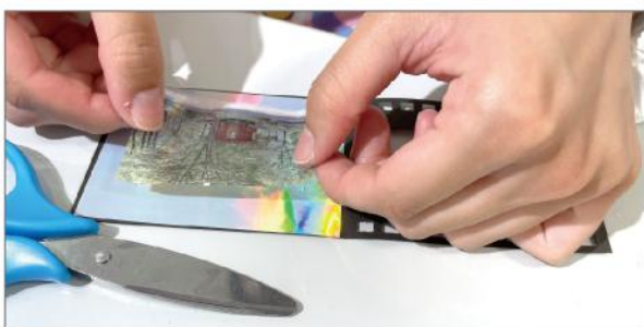
フィルムテープをホログラム台紙に貼り付けている様子
