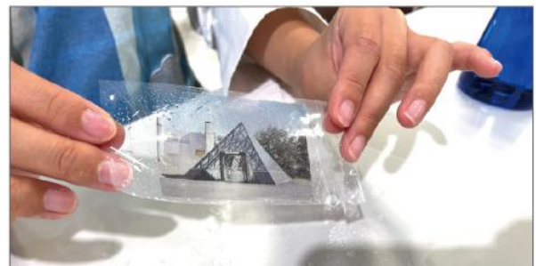
コピー用紙を剥がし取りフィルム化した様子
